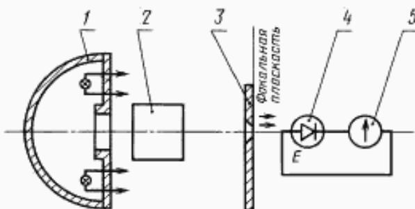
1 — осветитель; 2 — испытуемый объектив; 3 — диафрагма; 4 — фотоэлектрический приемник; 5 — гальванометр
