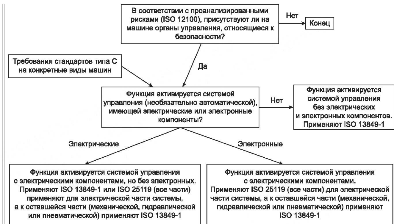
Рисунок Е.1 — Процесс снижения рисков и определения требуемых уровней производительности (Amd 1:2021)
