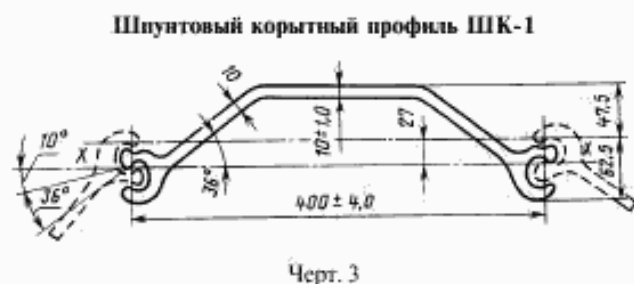
Замок шпунтового корытного профиля ШК-1
