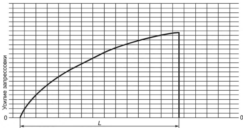
Рисунок 5а — Вид нормальной диаграммы запрессовки
