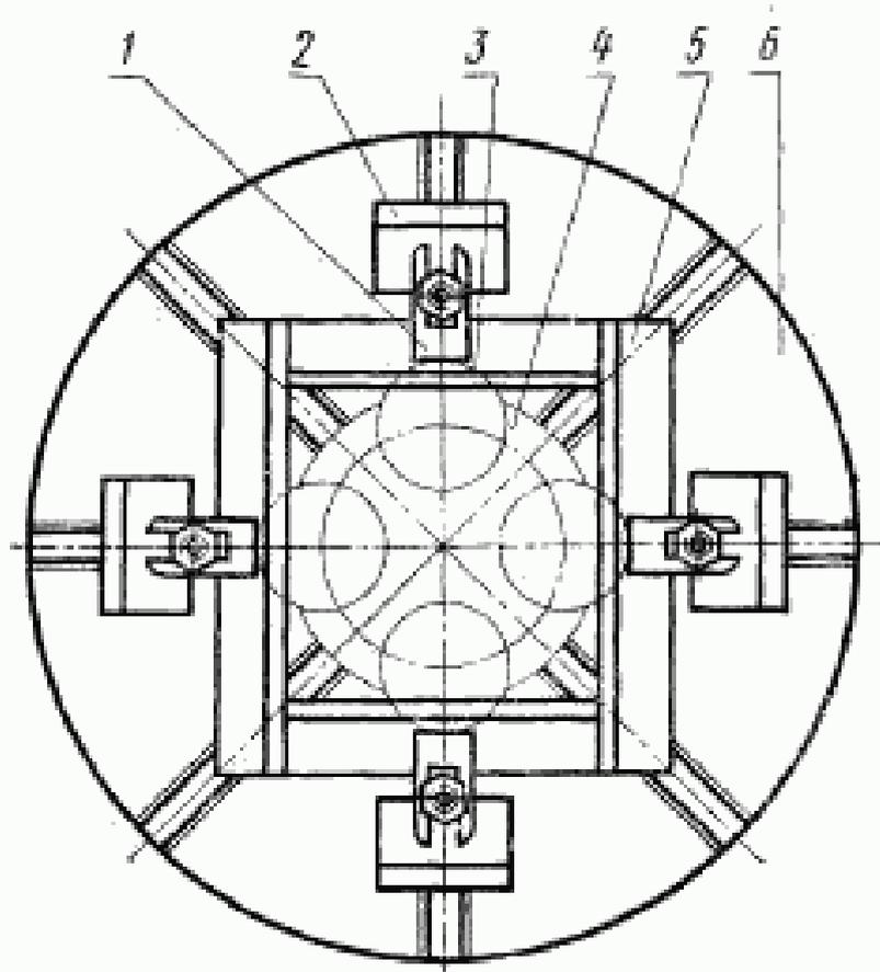
1—кронштейн; 2—подставка; 3—войлок; 4—испытываемое изделие; 5—брусок; 6—вибростенд; 7—гайка; 8—болт
