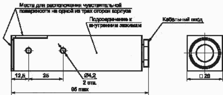
Рисунок А.1 (IC) — Габаритные размеры
