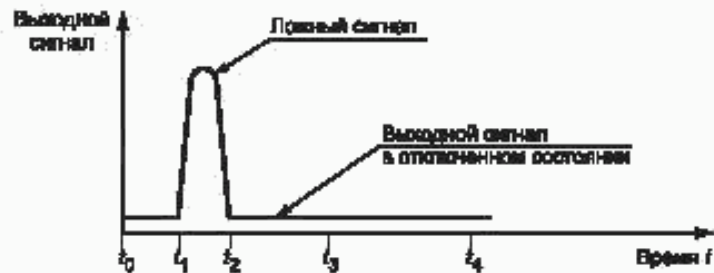
Рисунок 7б — Коммутационный элемент в выключенном состоянии
