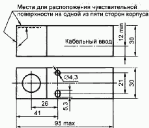
Рисунок А.1.3 (IC) — Габаритные размеры
