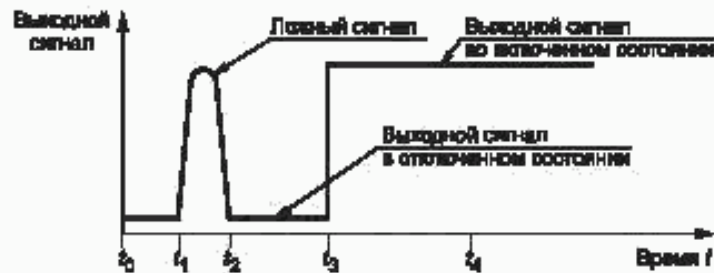
Рисунок 7а — Коммутационный элемент во включенном состоянии
