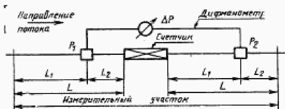
$P_1$  и  $P_2$  — отверстия для отбора давления:  $L_1 \geq 15 D$ ,  $L_2 \geq 10 D$ ,
