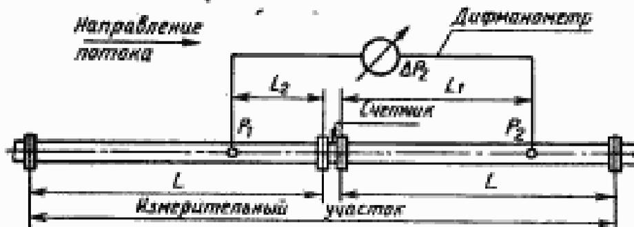
$\Delta P_2$  — потеря давления на участках трубопровода вверх и вниз по потоку и на счетчике:  $\Delta P_2 = (\Delta PL_2 + \Delta PL_1 + \Delta P_{сч})$ ;  $\Delta P_2 - \Delta P_1 = (\Delta PL_2 + \Delta PL_1 + \Delta P_{сч}) - (\Delta PL_2 + \Delta PL_1) = \Delta P_{сч}$
