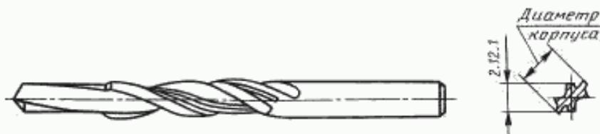
2.12.1 диаметр малой ступени (ступенчатого сверла): меньший диаметр ступенчатого сверла, который измеряется на всей длине рабочей части сверла, в том числе внутри корпуса с наибольшим диаметром.
