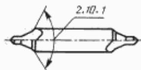
2.10.1 **угол предохранительного конуса (центровочного сверла):** вспомогательный угол к углу в плане на центровочном сверле с предохранительным конусом, предназначенный для выполнения защитной фаски в центровом отверстии заготовки
