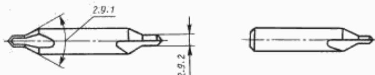
2.9.1 **зенкующий угол (сверла):** угол за сверловочной частью центровочного сверла, который образует конус в заготовке, базирующий центр
