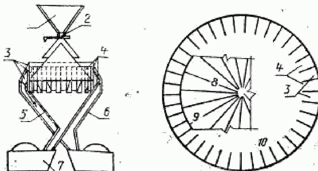
1 — загрузочная воронка; 2 — задвижка; 3 — емкость, открывающаяся во внешнюю воронку; 4 — каналы, отводящие поток во внутреннюю воронку; 5 — внутренняя воронка; 6 — внешняя воронка; 7 — основание; 8 — основание конуса; 9 — перья конуса; 10 — каналы, соединенные ниже основания конуса
