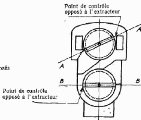
NOTE: Mode d'emploi du calibre vérificateur de la profondeur du drageoir.
