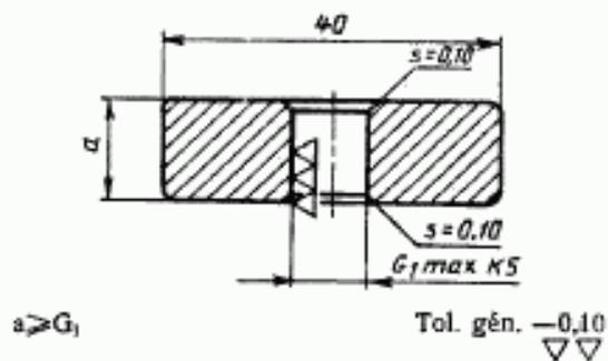
NOTE: Le projectile doit s'enfoncer complètement dans l'alésage de la bague.
