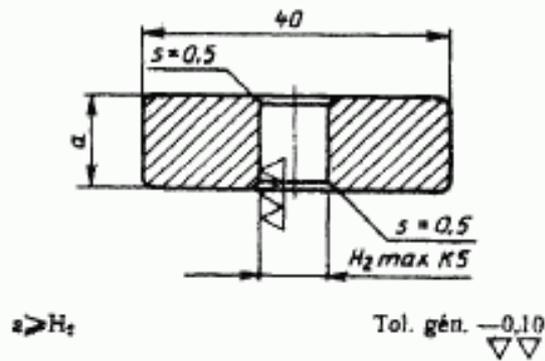
NOTE: Le collet de la douille doit entrer partiellement dans l'alésage du calibre suivant la conicité.
