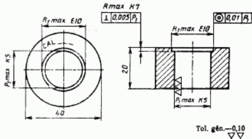
NOTE: Le bourrelet ne doit pas être en saillie par rapport à la face supérieure du calibre vérificateur.
