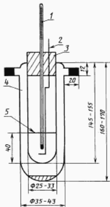
1 — термометр; 2 — мешалка; 3 — корковая пробка; 4 — пробирка; 5 — кольцевая метка
