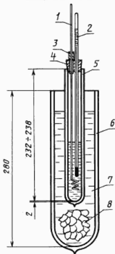
1 — мешалка; 2 — термометр; 3 — уплотнение; 4 — пробка;
