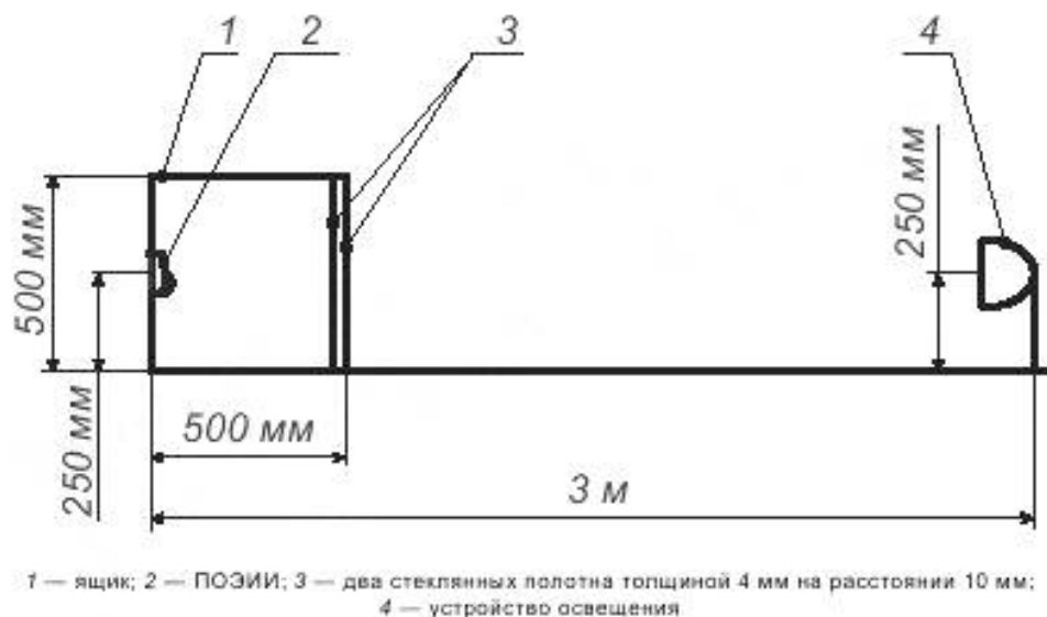
Рисунок 4 — Схема проведения испытаний на устойчивость к внешней засветке
