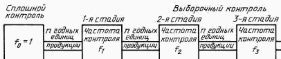
Рисунок 2 — Схема двухстадийного плана непрерывного контроля
