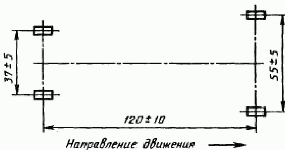
Рисунок В.3 — Места крепления растяжек к полу автобуса
