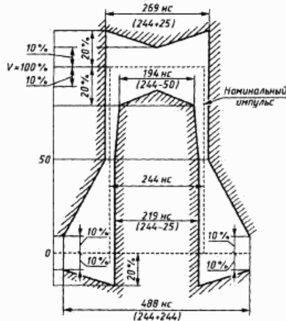
Чертеж Г.1 — Вид и форма импульса кодированного сигнала
