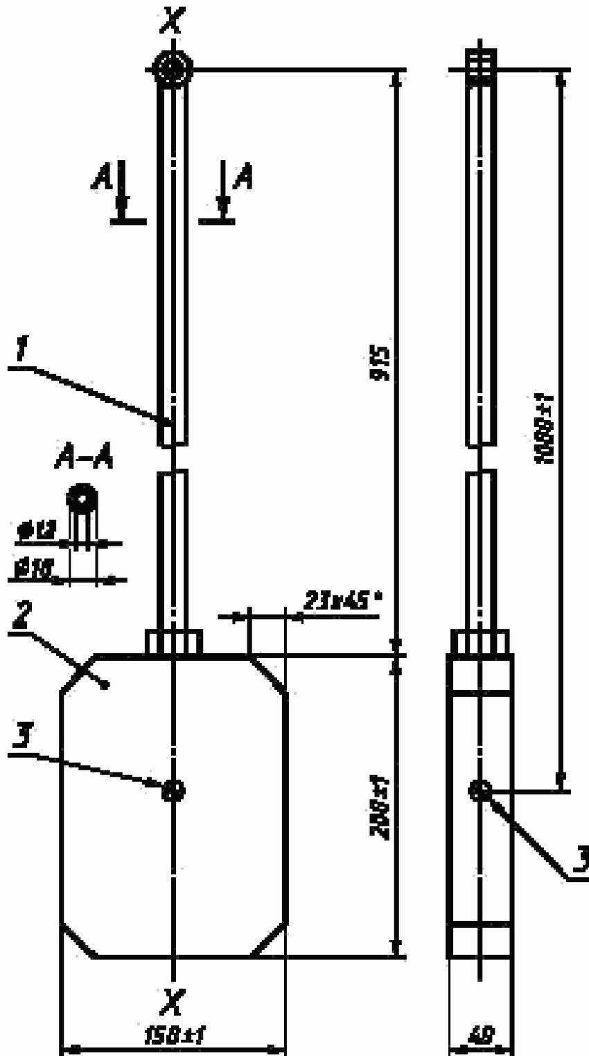
1 — стальная труба; 2 — стальной блок; 3 — центр удара.
