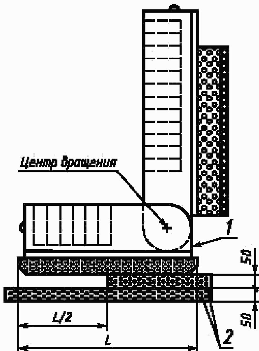
1 – испытательный манекен; 2 – пенопластовые прокладки
