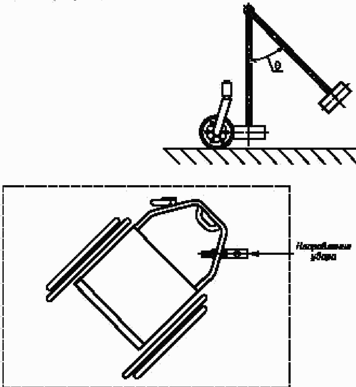
Рисунок 19 — Испытания поворотных колес кресла-коляски на ударную прочность
