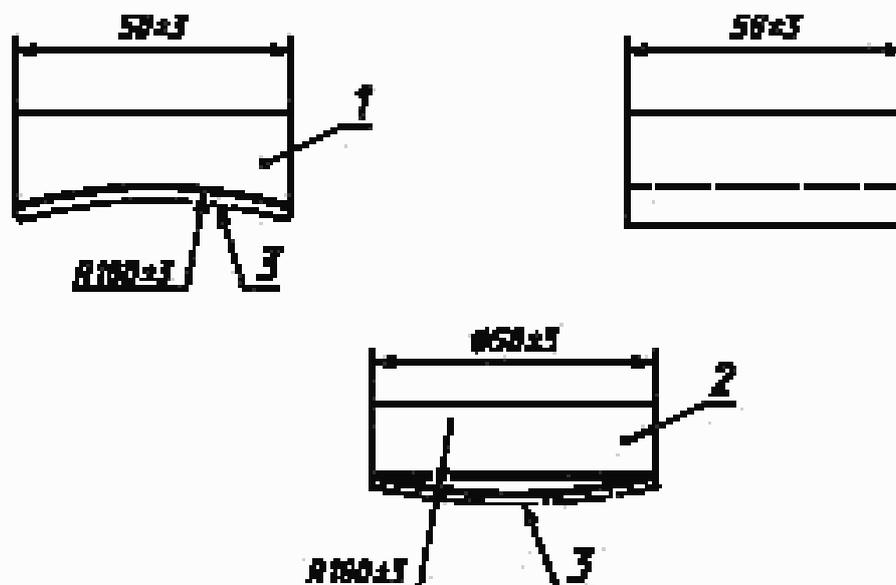
1 — вогнутая пластина; 2 — выпуклая пластина; 3 — нагружающая поверхность
