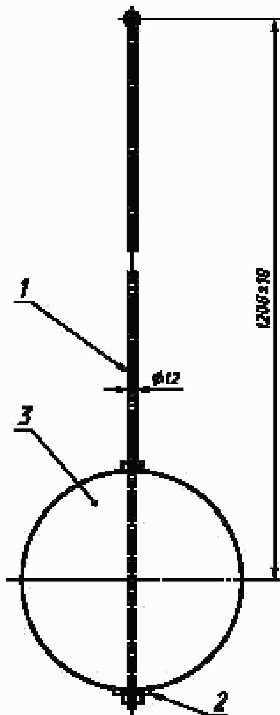
1 — винтовой стержень; 2 — прокладка  $\varnothing$  (50 $\pm$ 10) мм; 3 — шар, наполненный свинцовой дробью диаметром (3,5 $\pm$ 1) мм, с покрытием из пенопласта со следующими характеристиками: плотность (75 $\pm$ 15) кг/м<sup>3</sup>, твердость (325 $\pm$ 60) Н, сферичность  $\pm$ 20 мм. Общая масса шара (25 $\pm$ 0,5) кг
