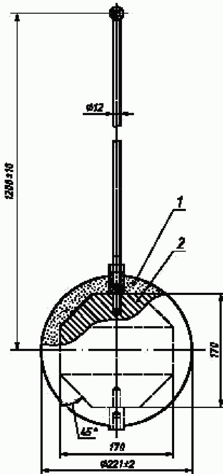
1 — полиуретан (плотность 1150 кг/м<sup>3</sup>, твердость 80 единиц Шора, упругость 20%); 2 — сталь.
