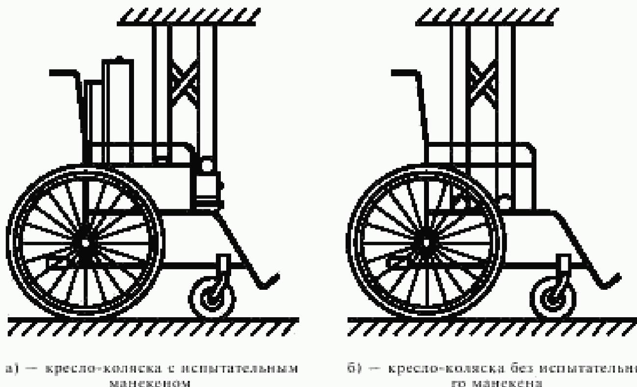
Рисунок 6 — Устройство, удерживающее кресло-коляску от опрокидывания
