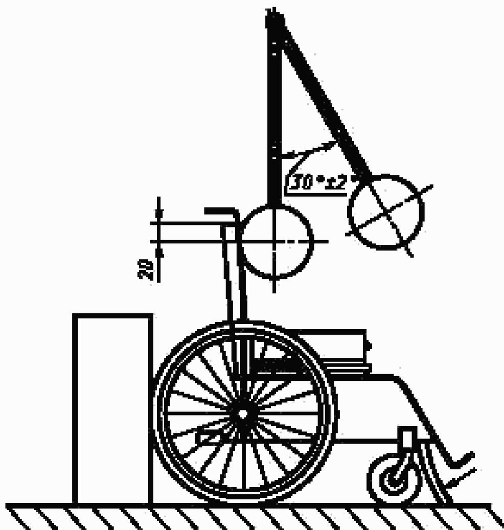
Рисунок 16 — Испытание спинки кресла-коляски на ударную прочность
