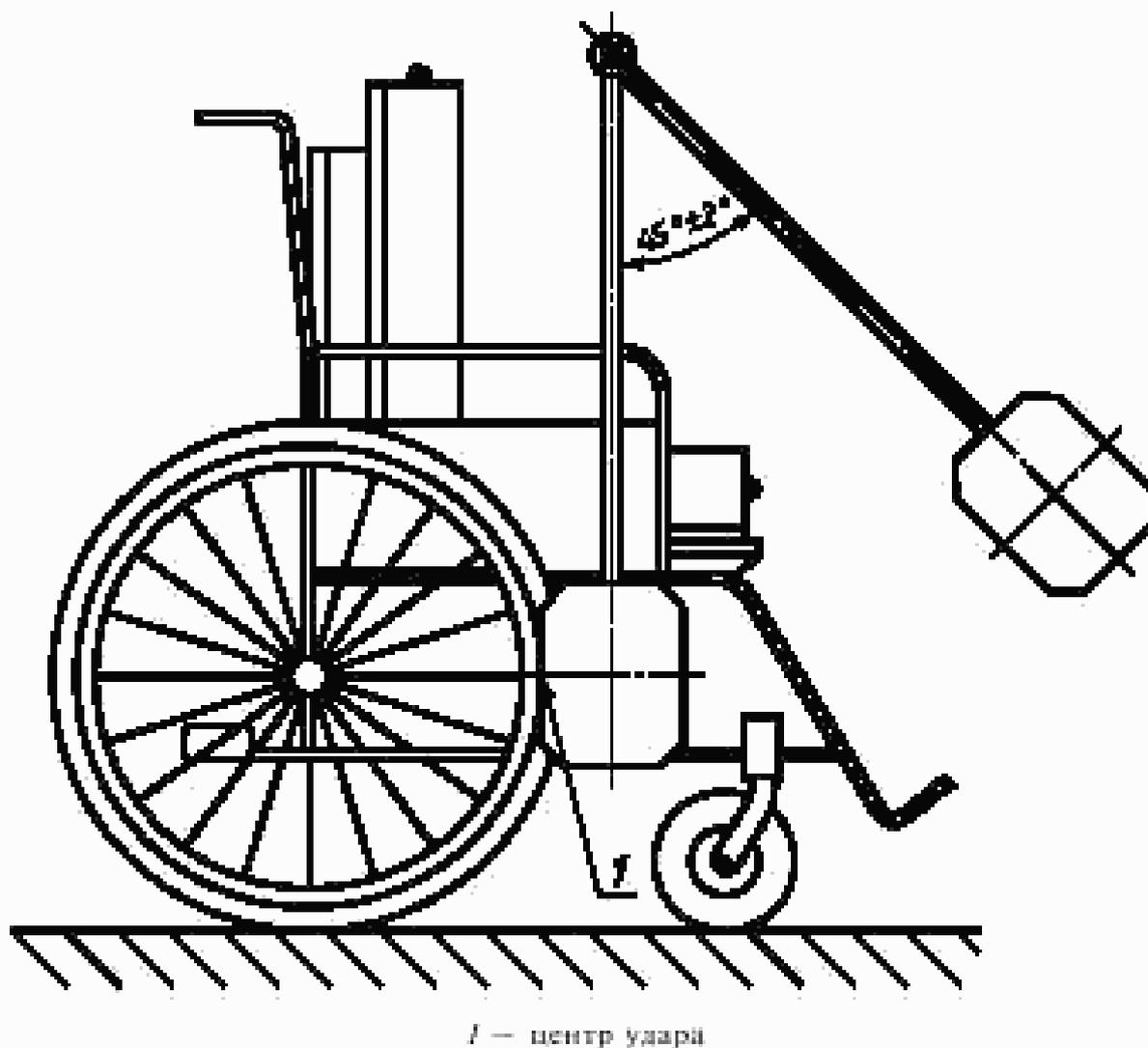
Рисунок 18 — Испытание ручного приводного обода кресла-коляски на ударную прочность
