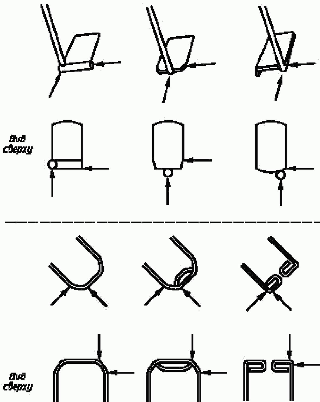
Рисунок 20 — Направление удара при испытании опоры стопы кресла-коляски на ударную прочность
