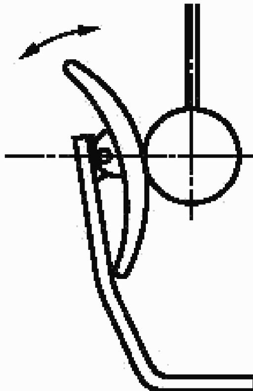
Рисунок 15 — Спинка кресла-коляски с самонастраивающимся углом наклона
