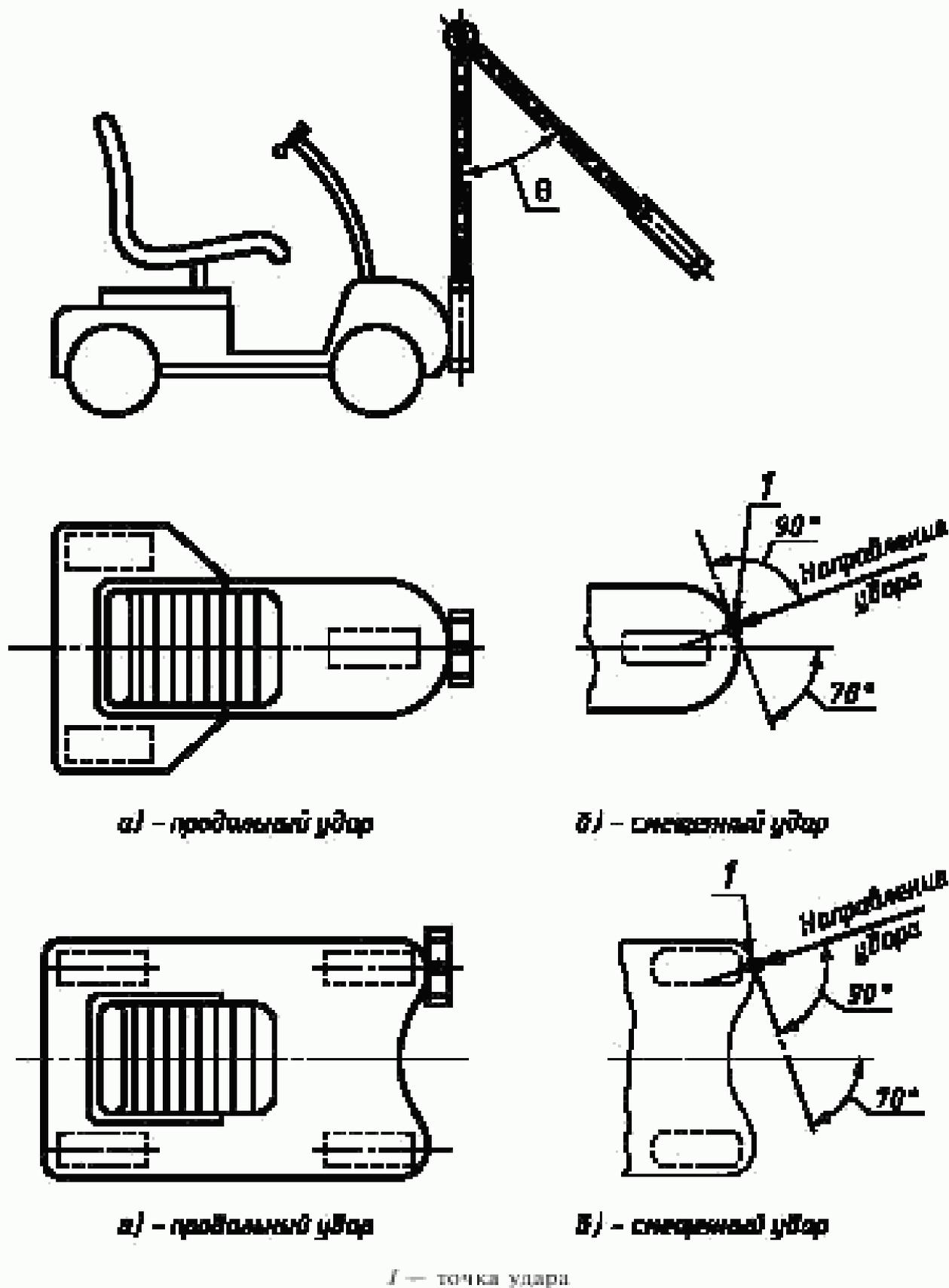
Рисунок 21 — Испытание кресла-коляски с электроприводом и скутера на ударную прочность
