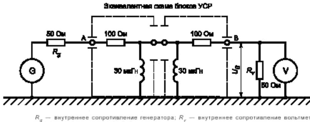
Рисунок С.5 — Измерительная установка для контроля вносимых потерь блоков УСР в полосе частот от 30 до 150 МГц
