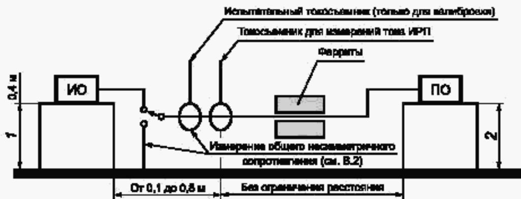
Рисунок В.4 — Измерения без подключения к экрану кабеля и применения эквивалента полного сопротивления сети
