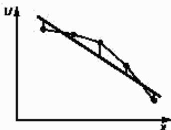
Рисунок Д.1 — Пример неприемлемости гипотезы линейности при F_{табл} < F
