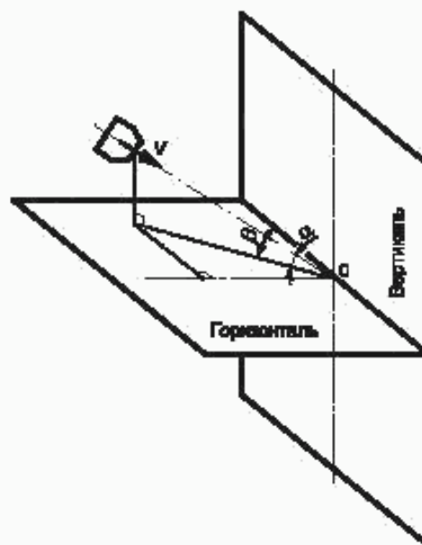
Рисунок 5 — Расположение испытательного оборудования для аппаратов типа С
