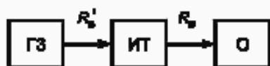
Рисунок 21 — Схема измерения верхней граничной частоты канала передачи сигналов изображения и размаха полного цветного телевизионного сигнала
