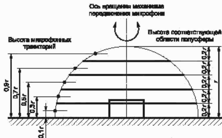
Рисунок Б.4 — Соосные круговые траектории в параллельных плоскостях для микрофонов, передвигаемых в свободном звуковом поле над звукоотражающей плоскостью
