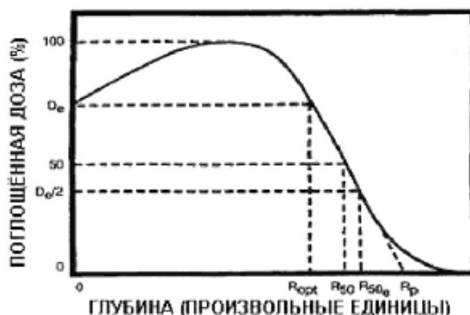
Рисунок 3 – Типичное (идеализированное) распределение дозы по глубине для электронного пучка в однородном материале, состоящем из элементов с низким атомным номером
