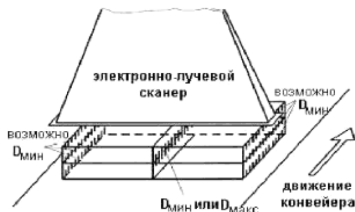
Рисунок 5 – Области D_{\max} и D_{\min} (показанные штриховкой) для случая прямоугольной технологической загрузки при двустороннем облучении электронным пучком
