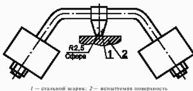
Рисунок 5 — Установка для испытания прочности материалов при нагревании
