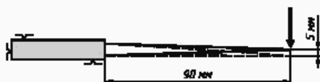
Рисунок 1 — Схема проведения испытаний на прочность и упругость ножей для выживания
