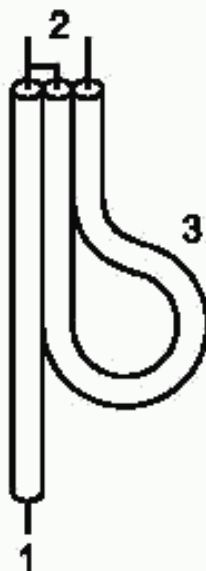
1 — несимметричный вход; 2 — симметричный выход; 3 — полуволновая петля
