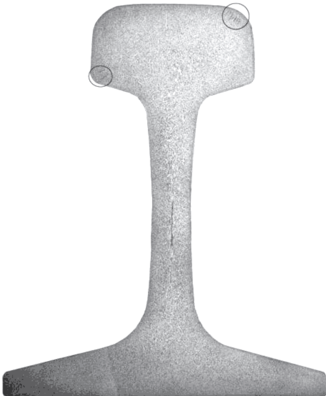
Рисунок И.15 — Группа ликвационных полосок с общей протяженностью более 6 мм при протяженности одной полоски более 3 мм (глубокое травление)
