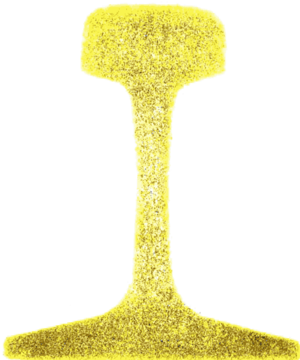
Рисунок И.1 — Макроструктура без ликвации (серный отпечаток)
