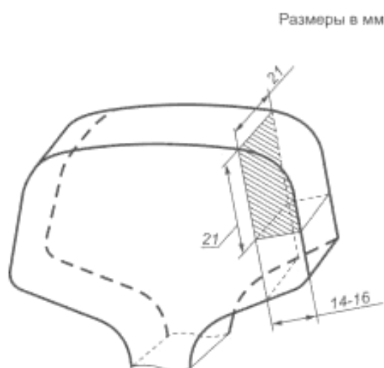
Рисунок 4 — Схема расположения шлица для контроля неметаллических включений
