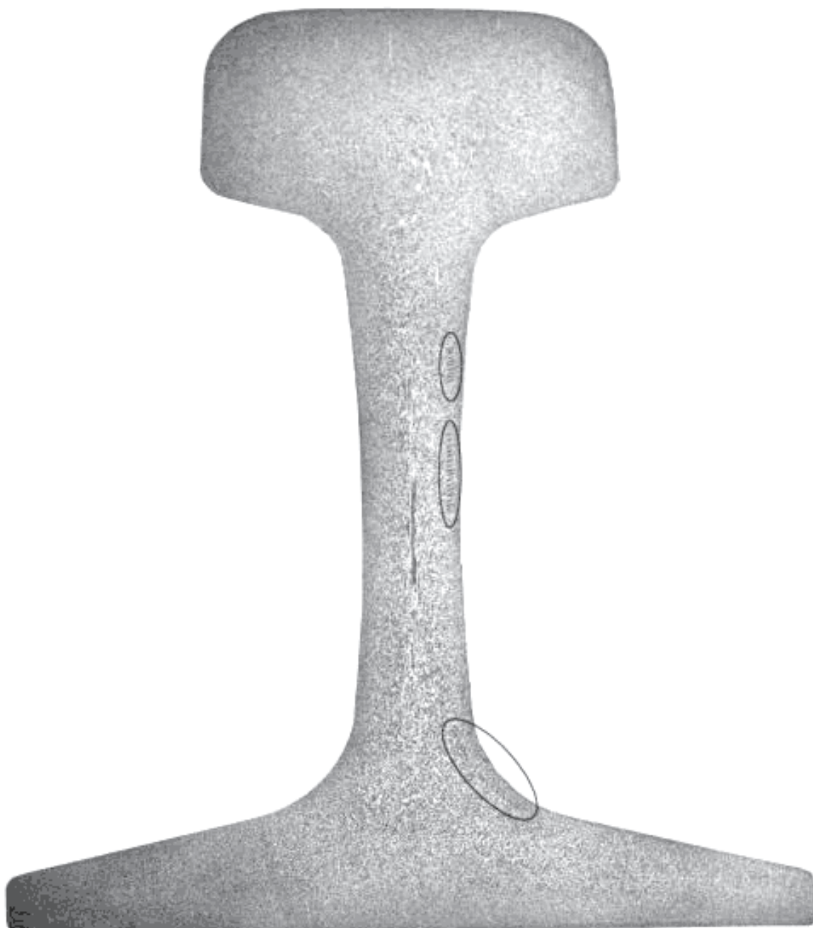
Рисунок И.16 — Группа ликвационных полосок с общей протяженностью более 20 мм при протяженности каждой полоски менее 3 мм (глубокое травление)
