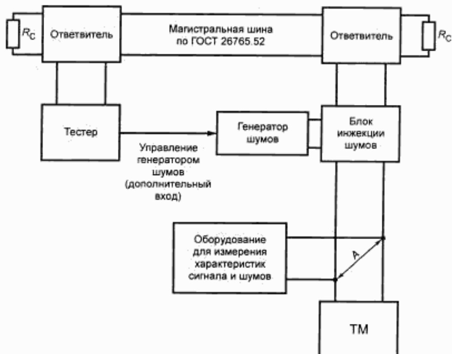
Рисунок 13 — Общая схема тестирования устойчивости к помехам ТМ при использовании магистральной шины
