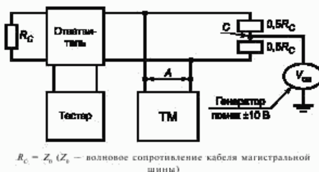
Рисунок 8 — Схема тестирования входного сигнала при синфазных помехах и непосредственном подключении ТМ
