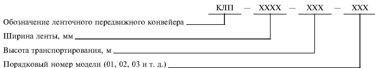
Пример условного обозначения ленточного передвижного конвейера с шириной ленты 500 мм, высотой транспортирования 4,5 м, третьей модели:
