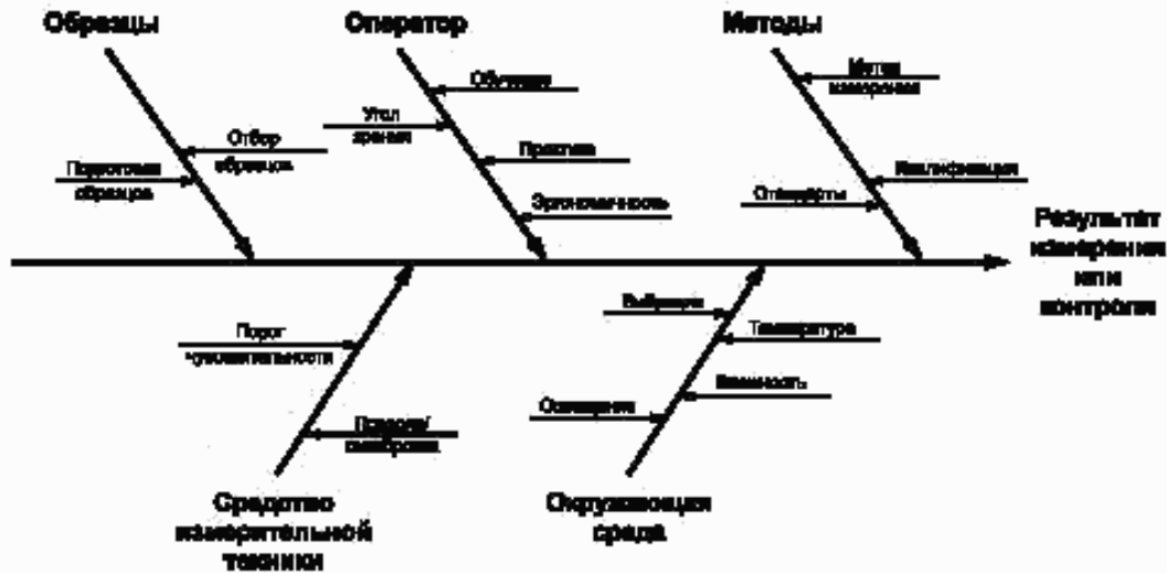
Рисунок 13 — Группы причин изменчивости измерительного или контрольного процесса
