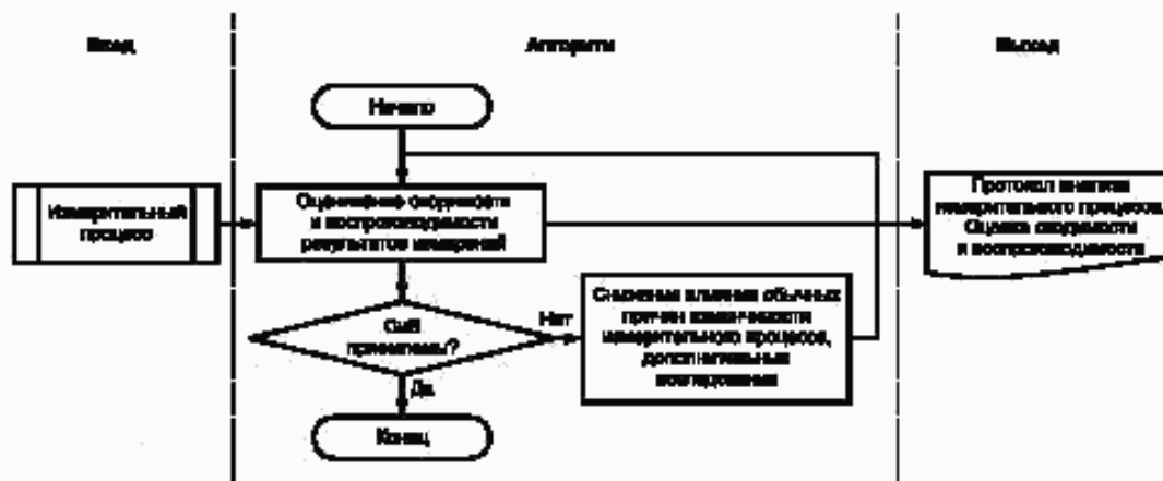
Рисунок 9 — Схема периодического оценивания сходимости и воспроизводимости измерительных процессов
