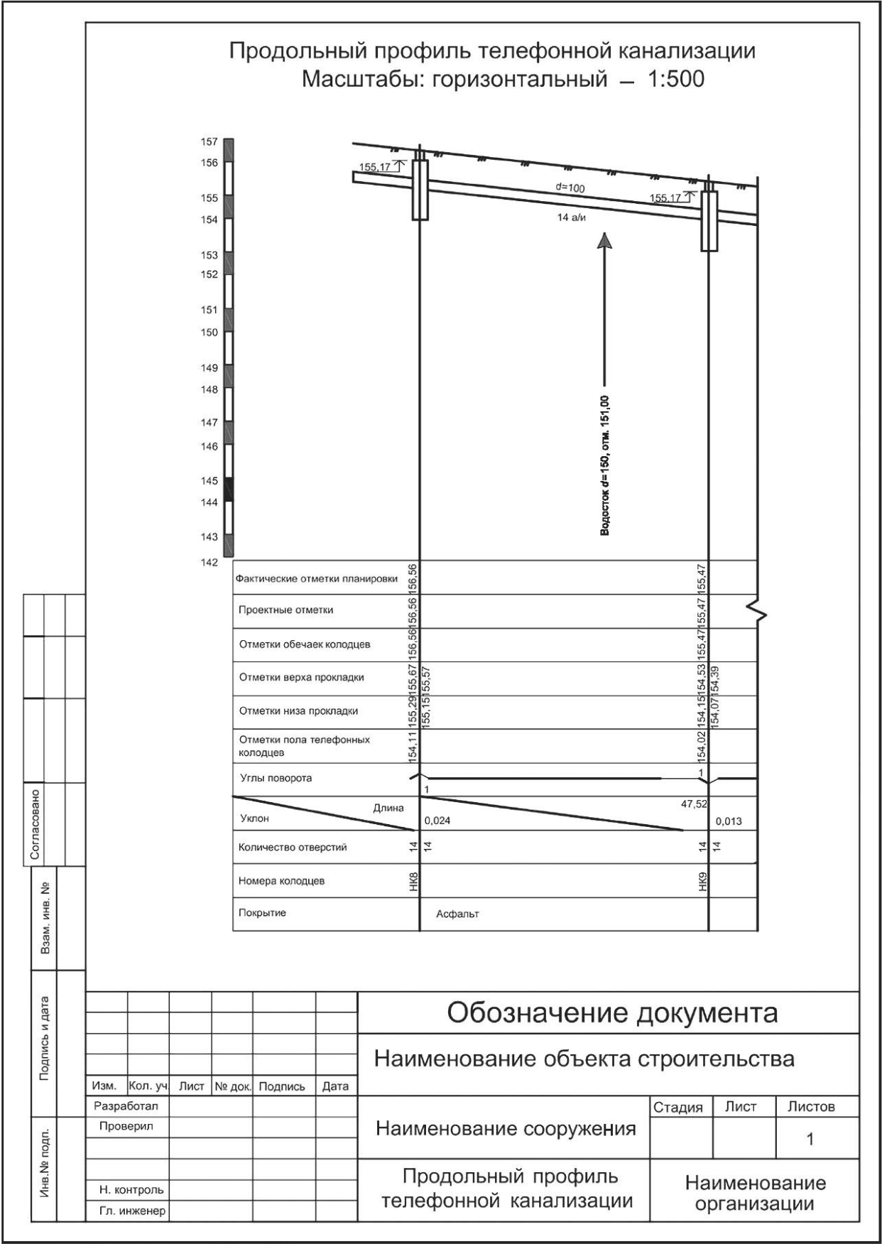
Рисунок Д.3 — Исполнительный чертеж телефонной канализации. Профиль
