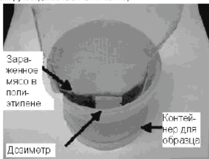
Рисунок 2 – Экспериментальная установка для облучения сырого мяса
