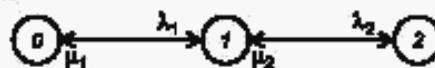
0 — состояние полного функционирования системы; 1 — ухудшенное состояние системы; 2 — неработоспособное состояние системы (состояние поглощения).
