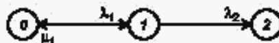
0 — состояние полного функционирования системы; 1 — ухудшенное состояние системы; 2 — неработоспособное состояние системы (состояние поглощения) системы.
