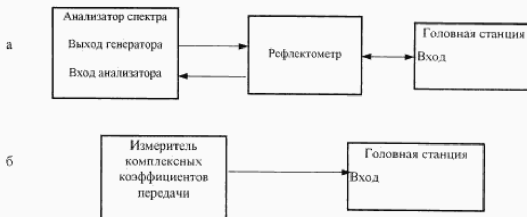
Рисунок 7.15 — Структурная схема для измерения затухания несогласованности
