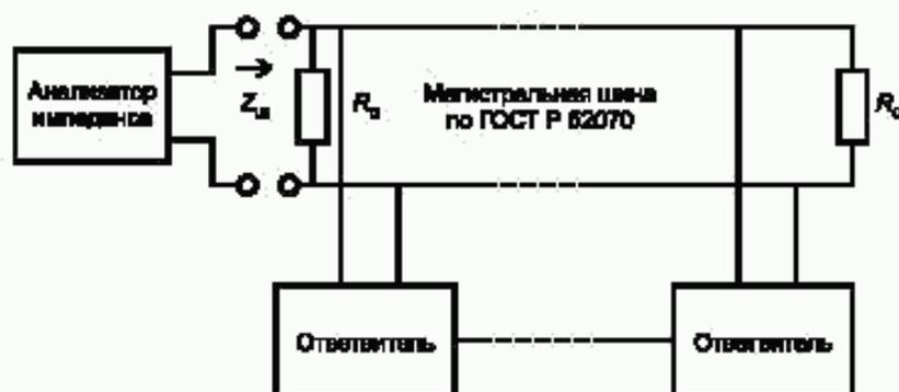
Рисунок 2 — Измерение импеданса магистральной шины
