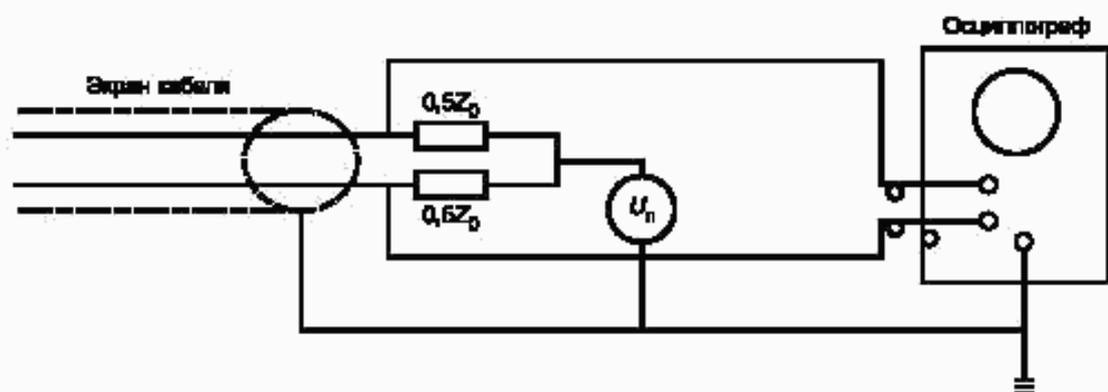
Рисунок 7 — Схема тестирования передачи при воздействии синфазных помех
