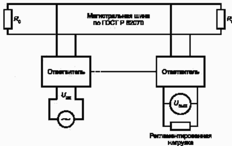
Рисунок 5 — Измерение затухания в магистральной шине/ответвителе
