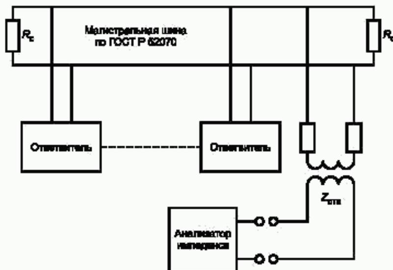
Рисунок 3 — Измерение импеданса ответвителя с трансформаторной связью
