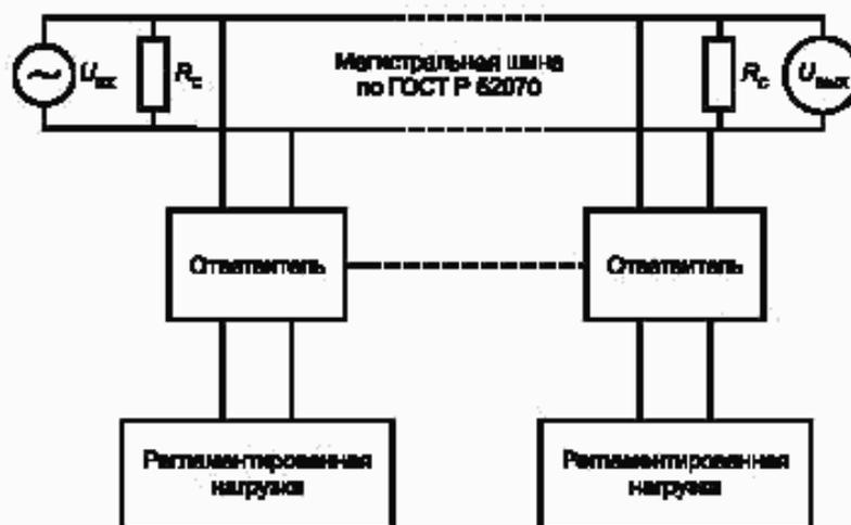
Рисунок 4 — Измерение затухания в магистральной шине
