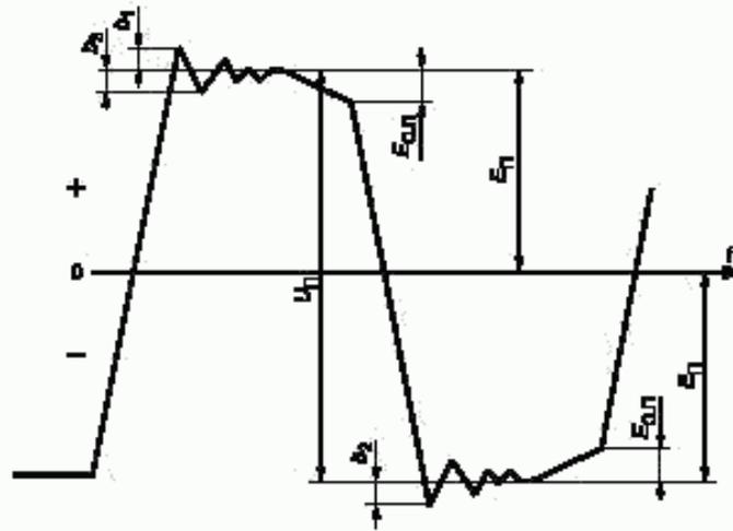
$U_{п}$  — размах сигнала;  $E_{с.п}$  — сход сигнала;  $E_{п}$  — амплитуда сигнала;  $b_1, b_2, b_3$  — выбросы и колебания сигнала
