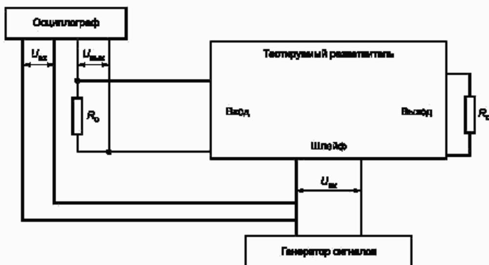
Рисунок 7 — Схема передачи сигнала от шлейфа к шине
