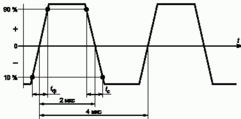
Рисунок 4 — Форма и параметры входного сигнала
