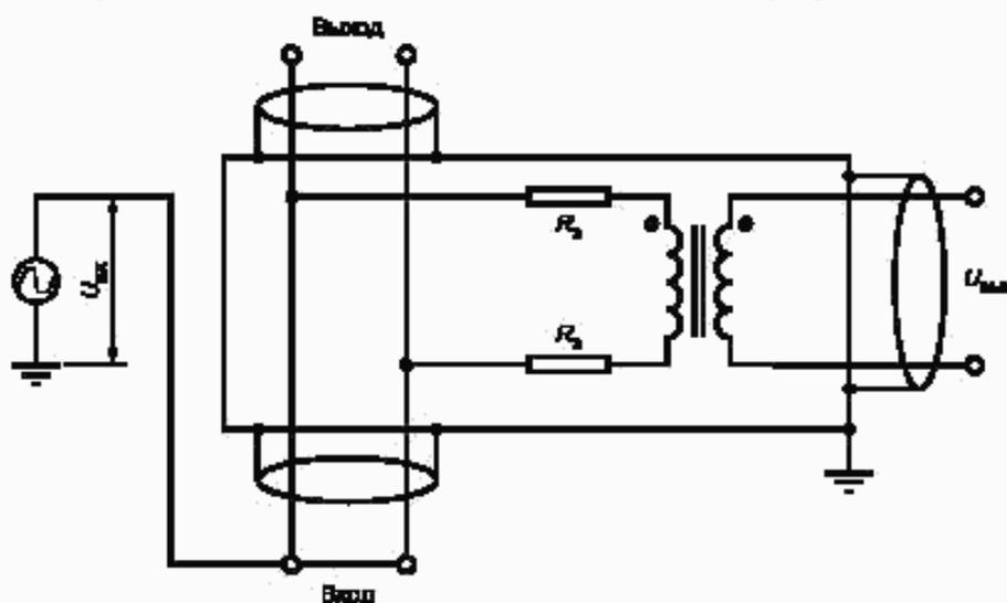
Рисунок 6 — Схема тестирования ослабления синфазного сигнала
