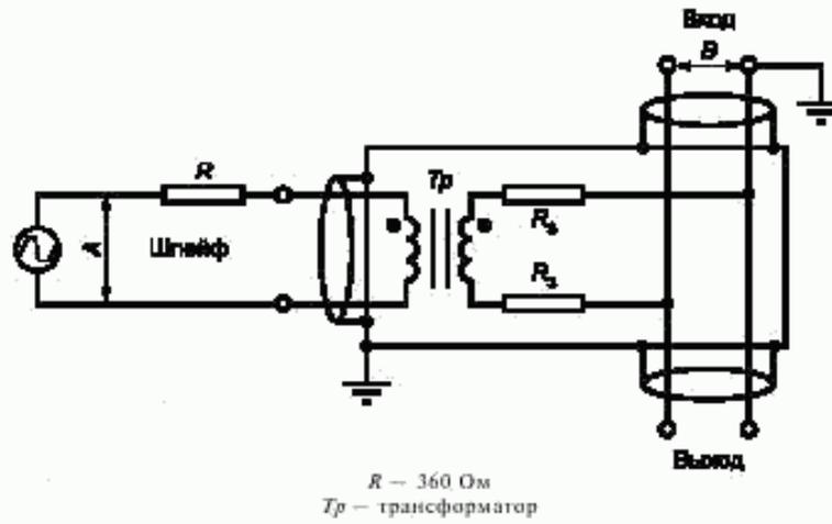
Рисунок 3 — Схема измерения выходного сигнала
