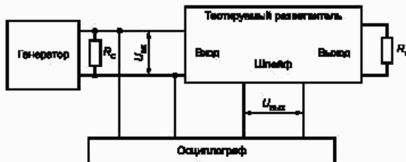
Рисунок 8 — Схема передачи сигнала от шины к шлейфу
