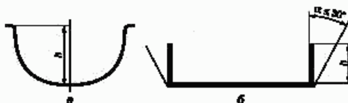
Измерение высоты бортиков участка скольжения горки с овальным дном
