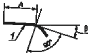
1 — стартовый участок; A — длина стартового участка; \beta — угол наклона стартового участка
