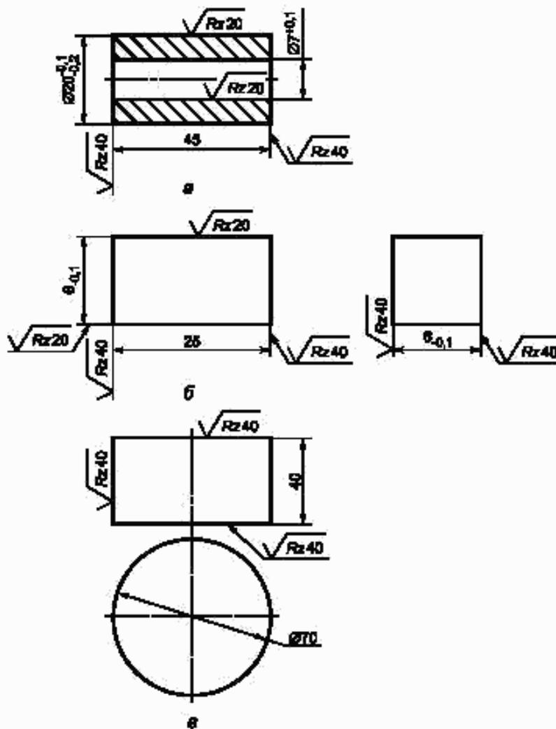
а, б — для моделирования соответственно линейного и поверхностного контакта при шлифовании; в — для сверления
