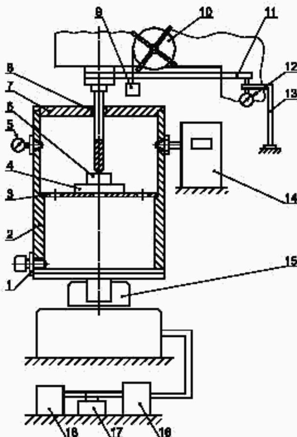
1 — штуцер для слива СОЖ; 2 — полый цилиндр; 3 — диск; 4 — обойма; 5 — манометр; 6 — обрабатываемая заготовка; 7 — крышка; 8 — манжета; 9 — груз; 10 — обод; 11 — пластина; 12 — отсчетное устройство (индикатор часового типа); 13 — штатив; 14 — насос для подачи СОЖ; 15 — столик динамометра; 16 — усилитель; 17 — осциллограф; 18 — миллиамперметр
