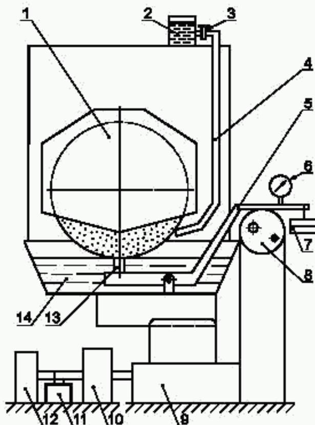
1 — шлифовальный круг; 2 — резервуар; 3 — кран; 4 — патрубок; 5 — коромысло; 6 — индикатор часового типа; 7 — набор грузов; 8 — эксцентрик; 9 — динамометр; 10 — усилитель; 11 — осциллограф; 12 — миллиамперметр; 13 — образец; 14 — ванна
