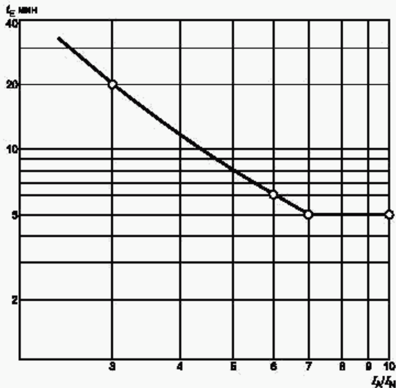
Рисунок 2 — График зависимости минимального значения времени t_E моторов от отношения пусковых токов I_A/I_N
