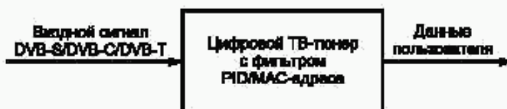
Рисунок 6 — Вывод данных пользователя с помощью цифрового ТВ-тюнера с фильтром PID/MAC-адреса
