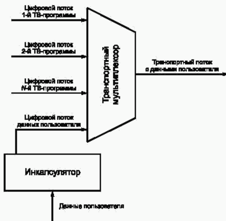
Рисунок 1 — Схема ввода данных пользователя на входе транспортного мультиплексора
