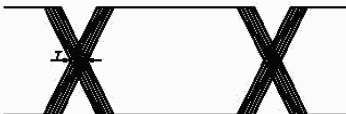
Рисунок 8 — Диаграмма, поясняющая измерение фазового дрожания цифрового сигнала
