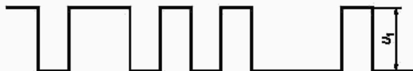
Рисунок 2 — Диаграмма, поясняющая измерение размаха сигнала
