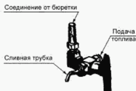
Рис. Б.2 — Типовой трехходовый кран для приготовления эталонных топлив
