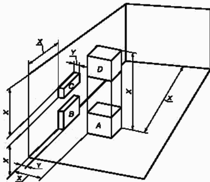
*A — оборудование вдали от стены; B — оборудование, монтируемое вблизи пола или потолка или в стене; C — оборудование, монтируемое на стене или в стене; D — оборудование, подвешенное к потолку или закрепленное на нем или вмонтированное в потолок; X — минимальное расстояние от соседних поверхностей помещения, равное 1,5 м, если иное не установлено изготовителем; Y — рекомендованное изготовителем минимальное выступление оборудования в помещение*
