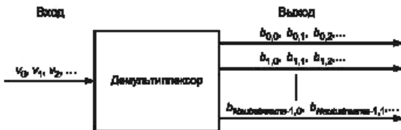
Рисунок 5 — Демультимплексирование потока битов на подпотоки
