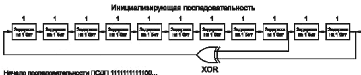
Рисунок 8 — Схема генератора опорной последовательности
