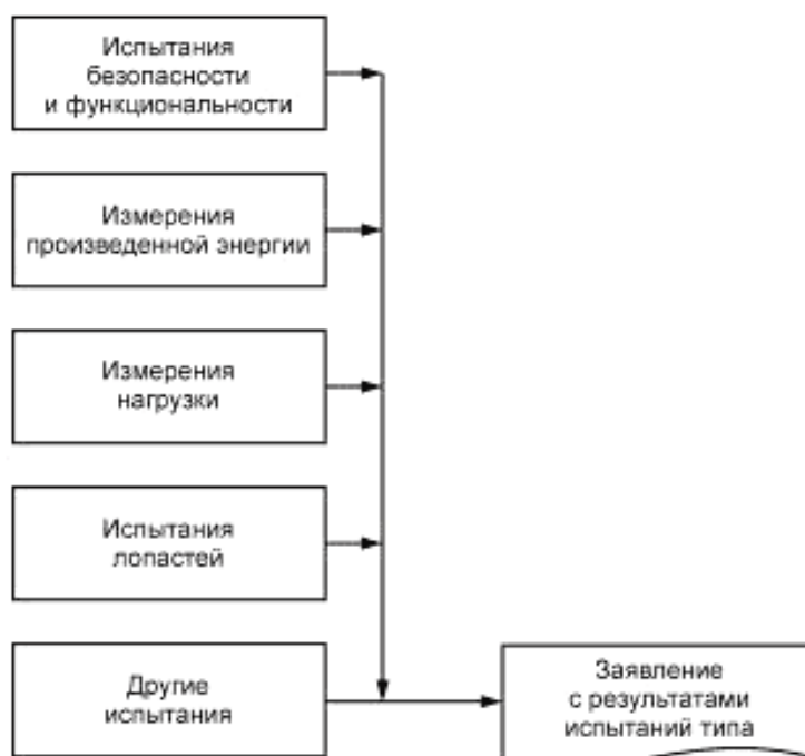
Рисунок 5 — Блок-схема процедуры типовых испытаний
