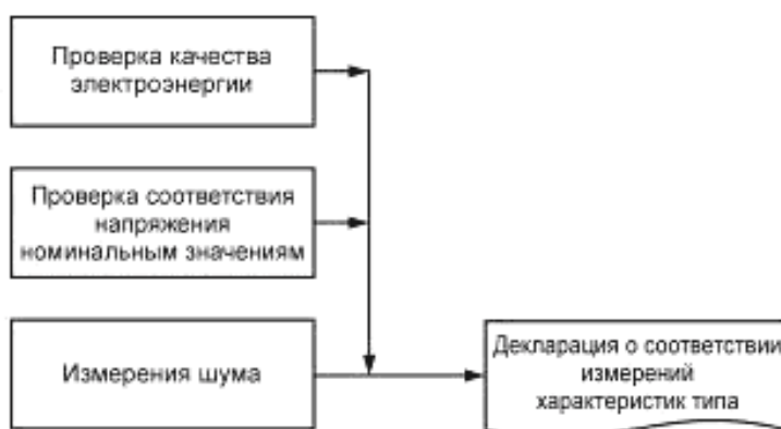
Рисунок 6 — Блок-схема элементов измерения характеристик типа
