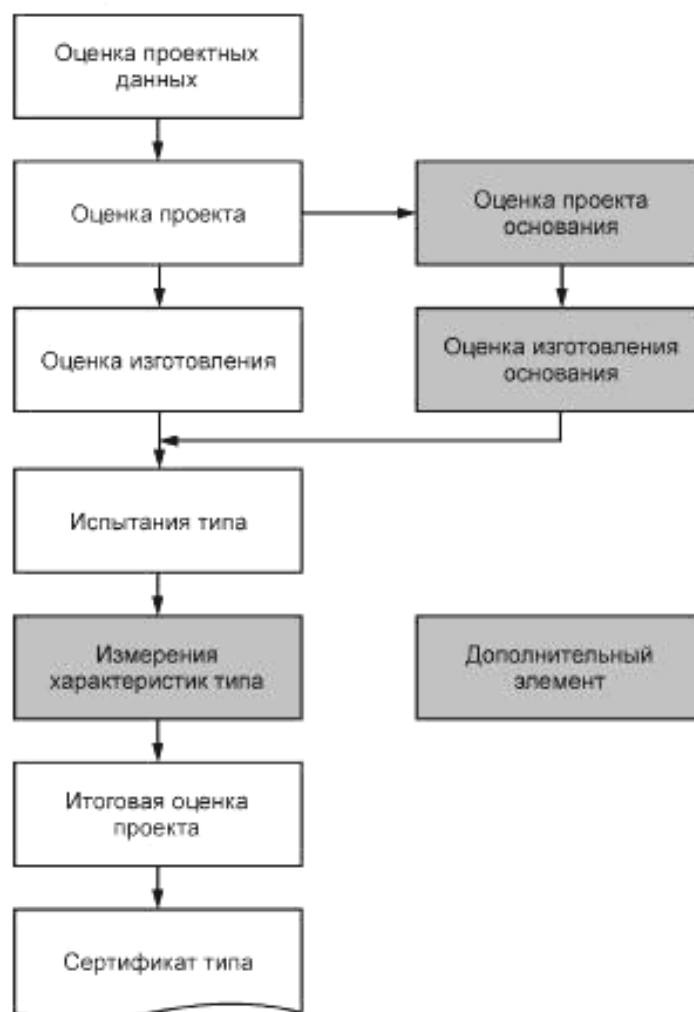
Рисунок 1 — Блок-схема процедуры сертификации типа
