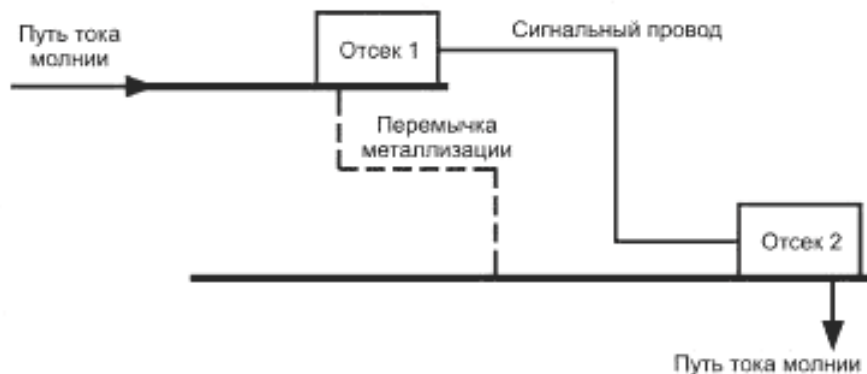
Рисунок G.1 — Два отсека управления, находящиеся на разных металлических плоскостях внутри гондолы
