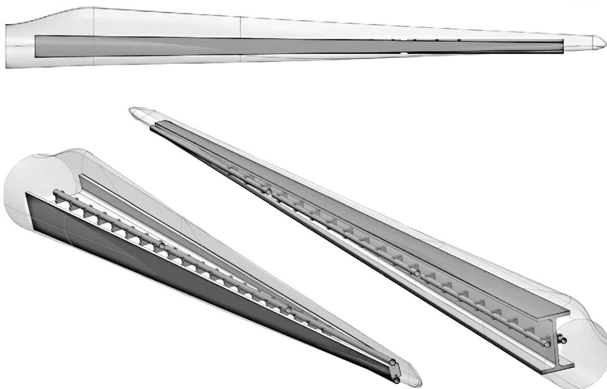
Рисунок I.1 — Пример геометрии для имитации распределения напряжения и тока в лопасти (покрытие лопасти добавлено для улучшения понимания)
