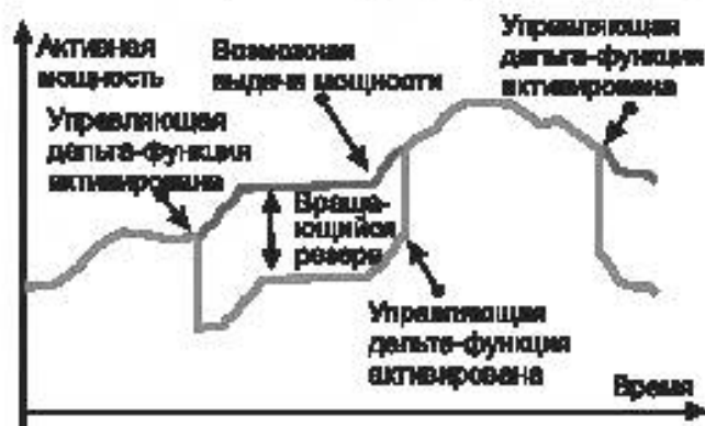
Рисунок В.4 – Схематическое изображение управляющей дельта-функции мощности
