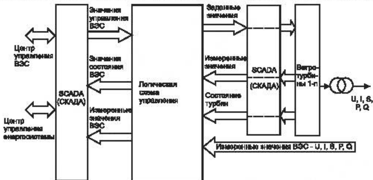
Рисунок В.1 – Концептуальная структура функций управления ВЭС
