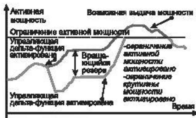
Рисунок В.5 – Схематическое изображение комбинированного регулирования мощности, включающее в себя регулирование мощности с помощью дельта-функции, градиента и ограничения активной мощности
