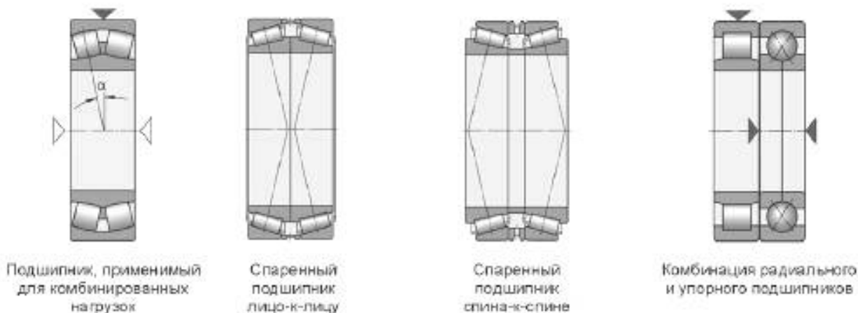
Рисунок 26 — Примеры расположений упорных подшипников
